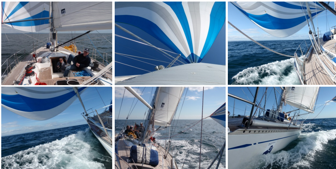
Das von Rod-Stagen stabilisierte 3-Saling-Rigg der SY Charisma trägt 180 qm Spinnaker.
