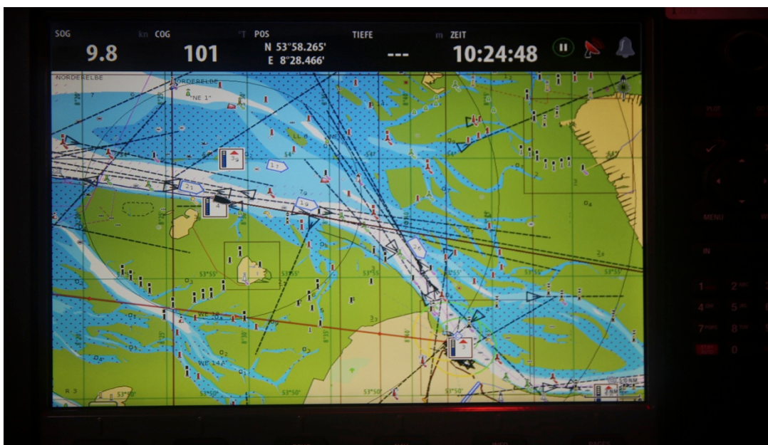
Die Abbildung der elektronischen Seekarte zeigt das Gezeitenrevier der Elbmündung samt Strömungen und den AIS-Symbolen der Schiffe im Fahrwasser der Elbe.
